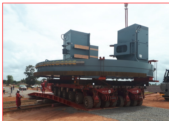
Módulo de car dumper cruzando sobre vía de tren
